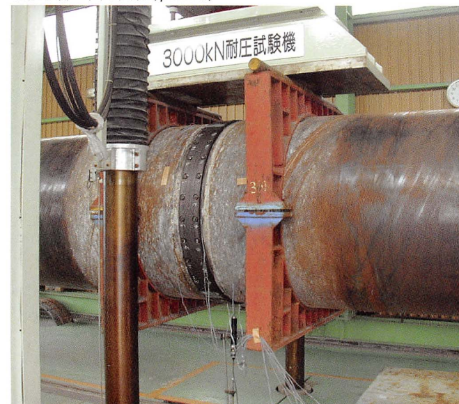
●継手部の曲げ試験(φ1200)
