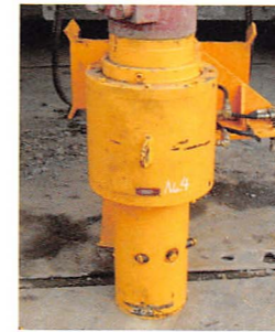
■油圧スイベル 油圧経路をオーガ内部に取り込む装置です。
