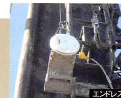
■オーガ深度計 オーガ先端の深度を計測します。深度計はこれ以外のタイプもあります。
