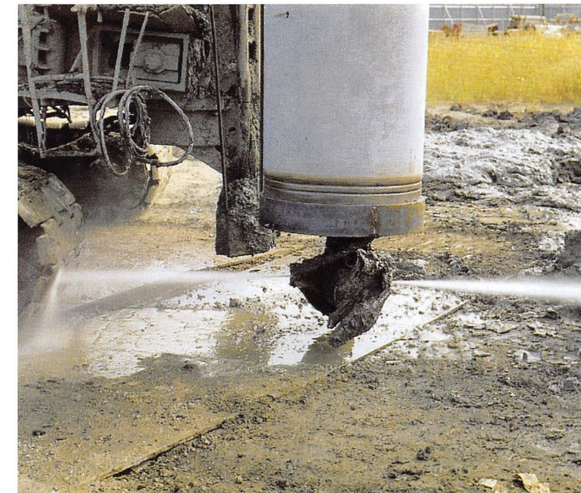
▼STJビット高圧噴射地上試験
